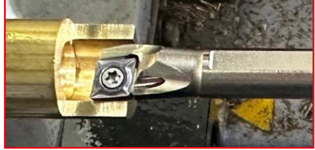
Çukurlu Bara Minimum işleme çapı 10 mm
